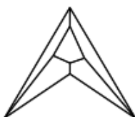
Figura 16: Exemplo de elemento boomerang.
