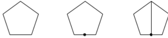
Figura 9: Quadrilaterização de um pentágono pela inserção de um vértice.
